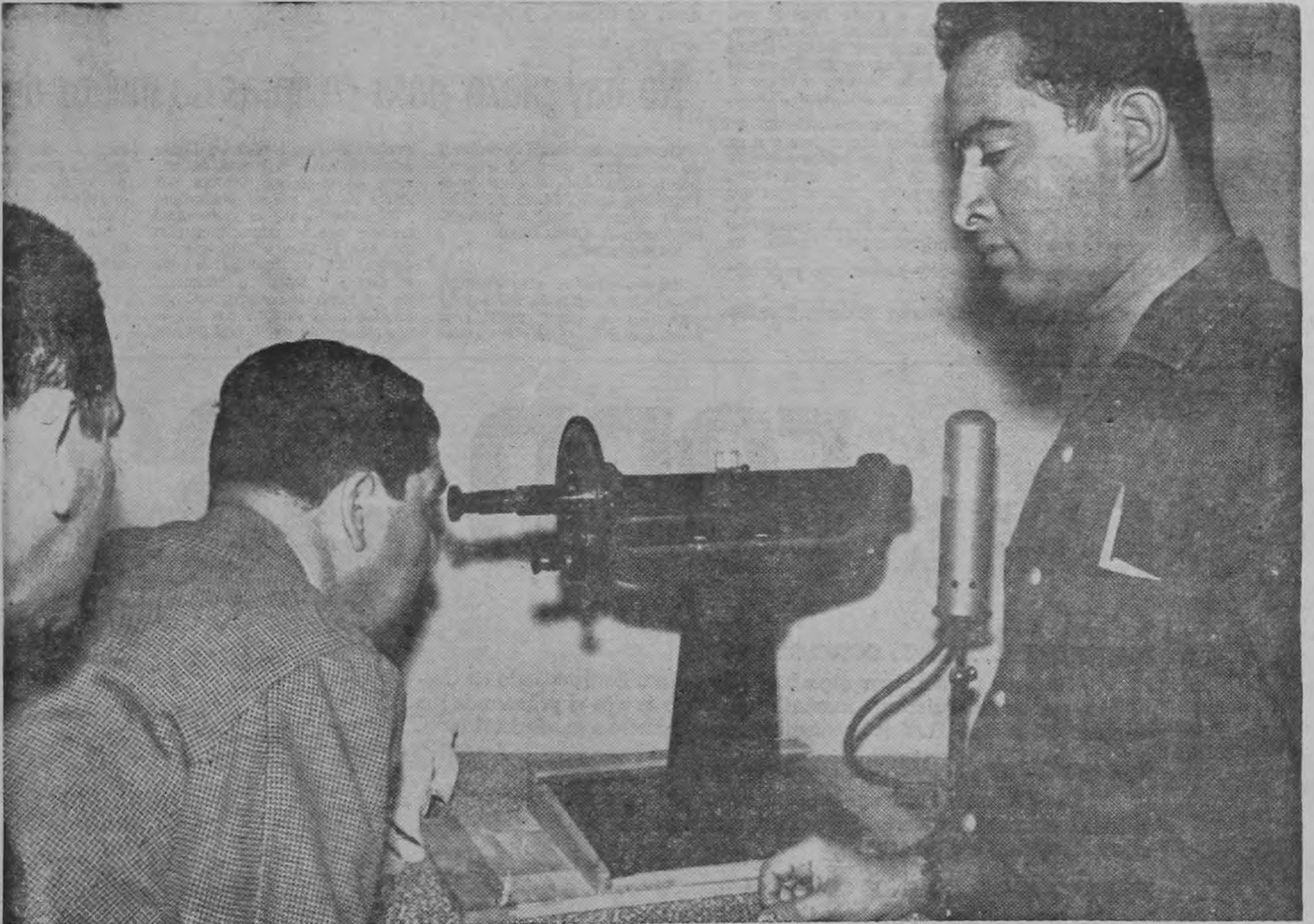
Don Ramiro Mata, acompañado de otro distinguido elemento de la Cámara de Comerciantes Detallistas, examinando, en el sacarímetro, la polarización de las muestras de azúcar tomadas en la bodega de la Junta de la Caña.
